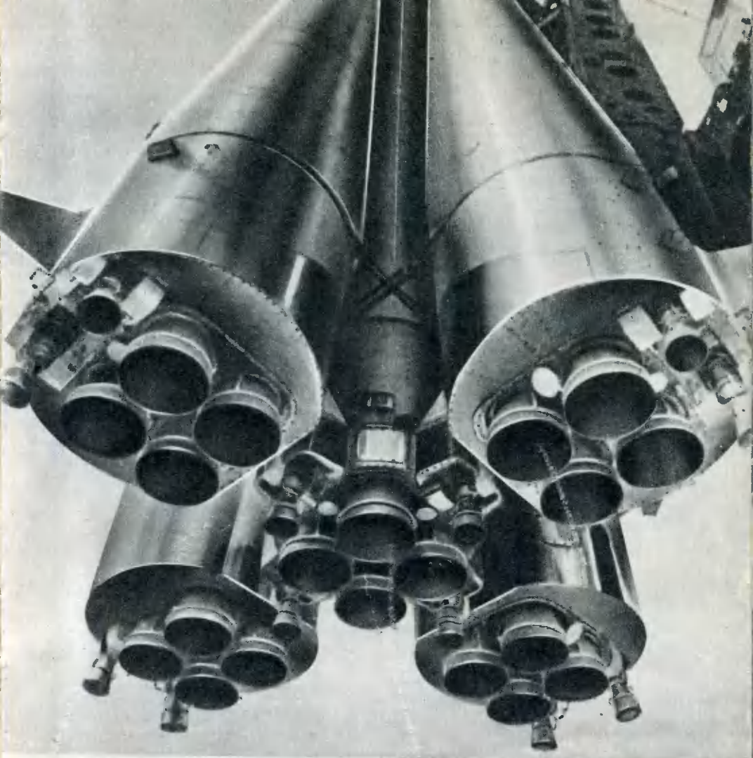
«Оркестр» ракетных труб «Востока». Видны четыре ракетных двигателя «РД-107» первой ступени ракеты-носителя и один (центральный) двигатель «РД-108» второй ступени.
